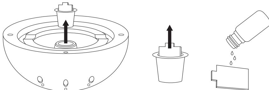
После этого поместите пластины в контейнер и установите его в исходное положение внутри очистной камеры. Затем установите корпус прибора на очистную камеру, совместив оба внутренних фиксатора (7) очистной камеры с соответствующими выступами на нижней части корпуса прибора. Помните, что при правильном соединении, корпус плотно прилегает к камере.
