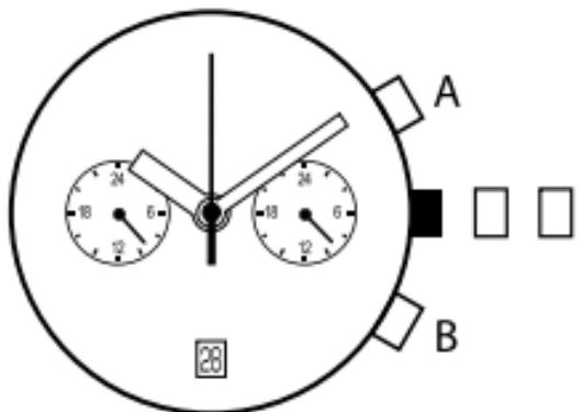
3. Appuyez sur le bouton A ou B pour remettre l'aiguille 24H du 2e fuseau horaire à zéro.
