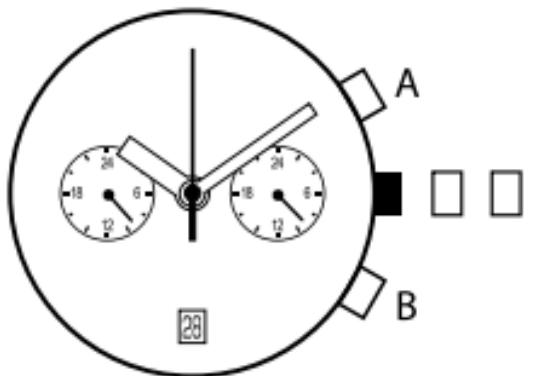
3. Нажмите кнопку «А» или «В», чтобы сбросить дополнительную 24-часовую стрелку на 0.
