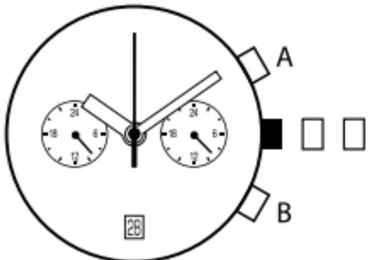
3. Drücken Sie Taste „A“ oder „B“, um eine Rücksetzung des 24-Stundenzeiger für die Dualzeit in die „0“-Stellung auszuführen.
