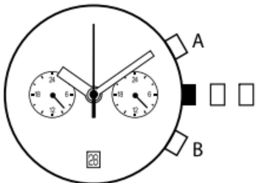
3. Pressione a tecla A ou B para ajustar o ponteiro de 24 horas da hora dual à posição "0".
