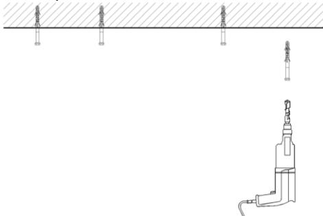
3. Каждую планку зафиксировать болтами с двух сторон (входят в комплектацию монтажной планки).
