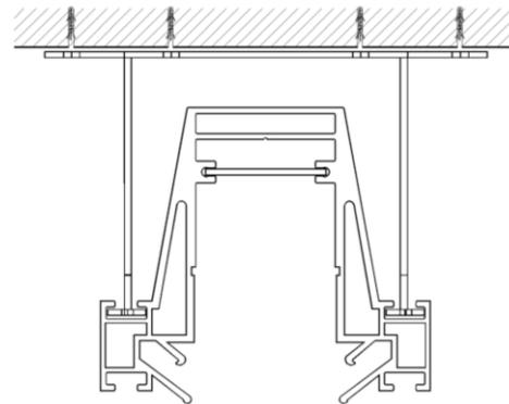
5. При помощи болтов зафиксировать на потолке монтажную планку. Каждая планка фиксируется 4мя болтами.
