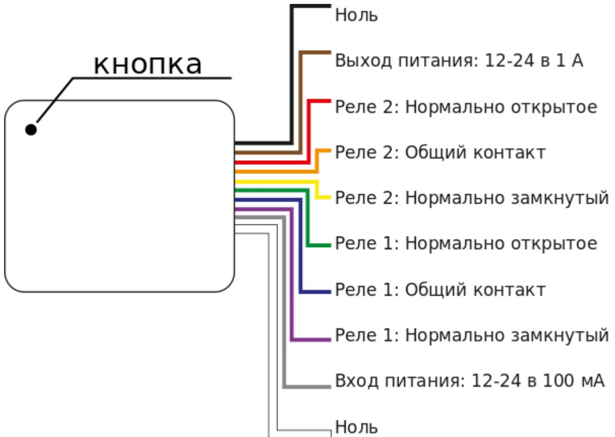
Устройство имеет 10 проводов смонтированных в отсоединяемый разъём и 1 кнопку которая используется для включения/исключения или настройки устройства.
