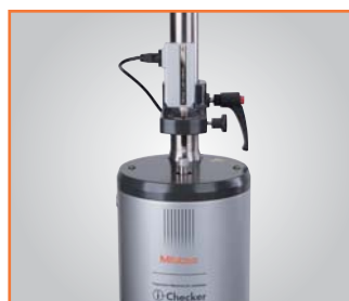
Калибровка датчика линейных перемещений
