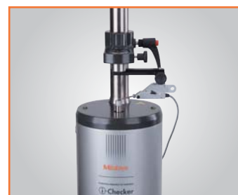
Калибровка индуктивного датчика
