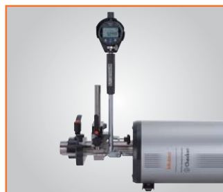
Калибровка двухточечного нутромера (с набором тип C)
