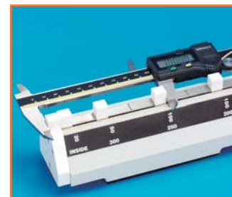
Проверка точности штангенциркуля (измерение внешних размеров)
