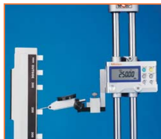
Проверка точности штангенрейсмаса
