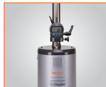
Калибровка цифрового индикатора
