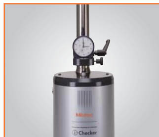
Калибровка индикатора часового типа
