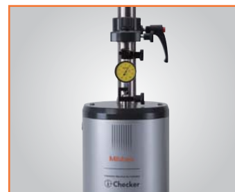
Калибровка индикатора рычажно-зубчатого
