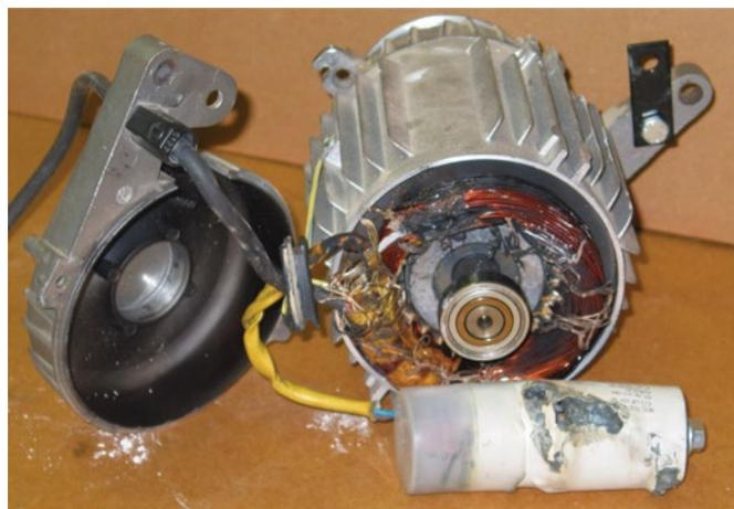
*Работа компрессора при пониженном напряжении привела к сгоранию обмоток электродвигателя и оплавлению конденсатора.*
