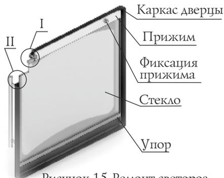
Рисунок 15. Ремонт светопрозрачного экрана дверцы модели «Витра»
