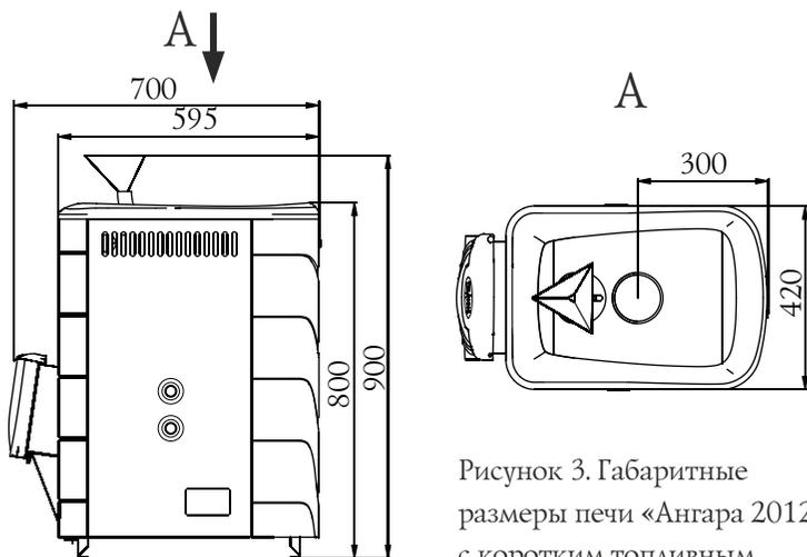
Рисунок 3. Габаритные размеры печи «Ангара 2012» с коротким топливным каналом.
