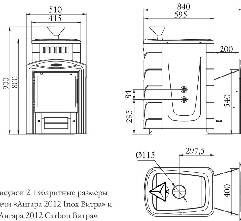
Рисунок 2. Габаритные размеры печи «Ангара 2012 Inox Витра» и «Ангара 2012 Carbon Витра».
