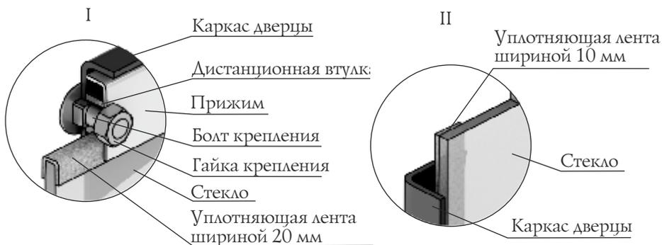
Рисунок 16. Крепление светорозрачного экрана дверцы модели «Витра»
