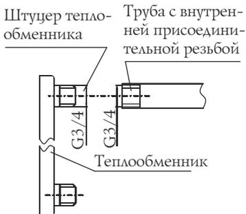
Рисунок 13. Присоединение трубопровода напрямую.
