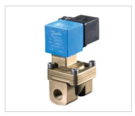
EV220W — это компактные двухпозиционные/ двухходовые сервоприводные электромагнитные клапаны непрямого действия с соединением от 3/8" до 2", специально разработанные для работы в условиях ограниченного пространства.
