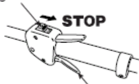
Throttle trigger Ignition switch=Включение зажигания Throttle trigger=Курок дросселя
