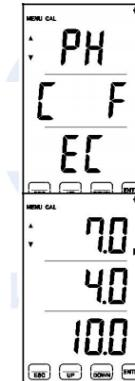
3. Режим CAL отобразит на экране "PH", "C F" и "EC". Выберите "PH" нажатием на кнопку [ENTER] для входа в режим калибровки pH.
