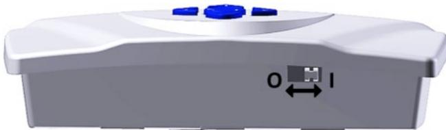
Переведите переключатель в положение „O“, чтобы перевести термостат в режим ожидания. Дисплей выключится, чтобы уменьшить расход заряда батареи. Кнопки (+), (-), (◀) и (▶) заблокированы. При длительном нажатии кнопки (OK) на дисплее отображаются фактическая температура и время вместе с символом :
