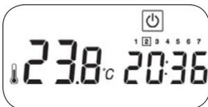
Установите переключатель в положение „I“, чтобы включить термостат. Версия программного обеспечения отображается в течение трех секунд. Затем термостат вернется из режима ожидания в ранее выбранный режим работы.
