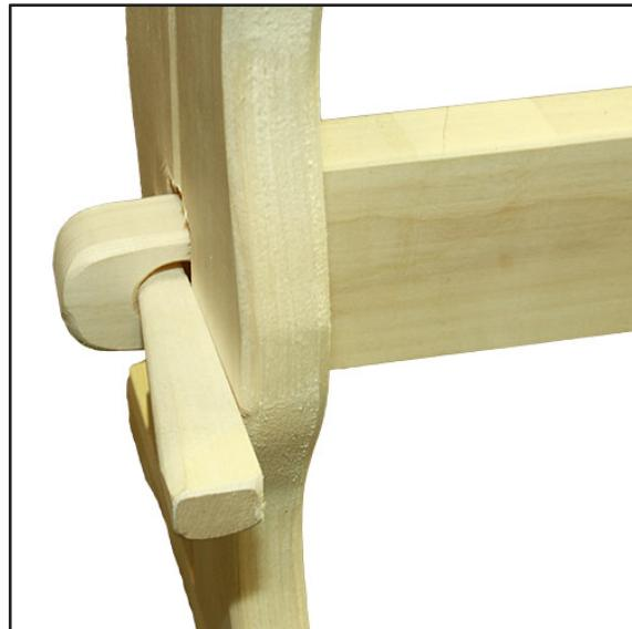
**1.** Вставьте ушко поперечины в прямоугольное отверстие ножки и неплотно зафиксируйте клином. Аналогично присоедините вторую ножку.
