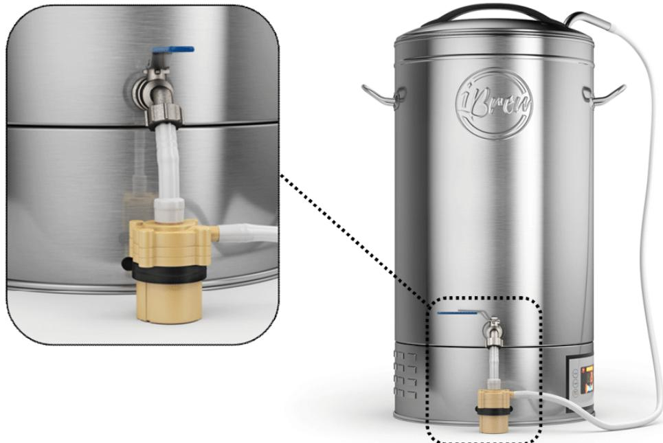
Насос забирает сусло через кран и подает по трубке вверх, где через специальное отверстие в крышке сусло льётся на дробину. Регулировать поток сусла можно при помощи крана.
