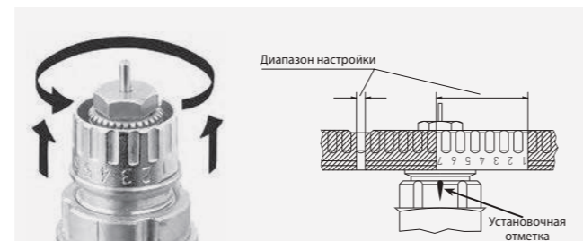
Рис. 11. Предварительная настройка клапана Danfoss
