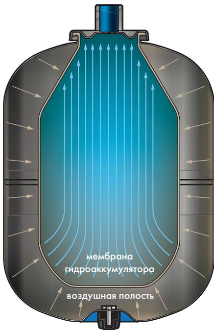
В исходном состоянии в гидроаккумулятор через воздушный клапан (ниппель) закачан воздух до давления 1,5 атм.
