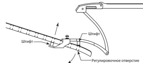
**3** Передвиньте ремешок вправо или влево на соответствующую длину, а затем надежно вставьте штифты в регулировочные отверстия в тех же 2 местах.
