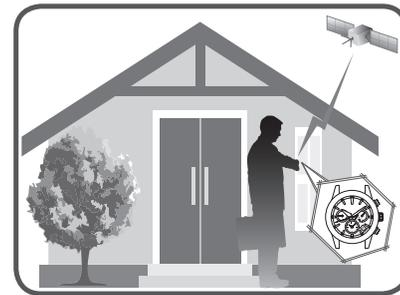
\* В отличие от навигационного оборудования, эти GPS часы на солнечной батарее не предназначены для непрерывного получения GPS сигналов от спутников GPS без выполнения необходимых действий. Эти часы получают GPS сигналы только в режиме настройки часового пояса или ручной настройки времени.
