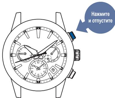
\* При нажатии и удерживании кнопки А часы переходят в ручной режим настройки времени.
