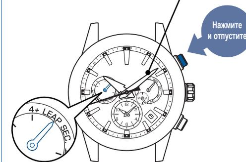
\* При удержании кнопки А в нажатом положении часы переводятся в режим ручной настройки времени.
