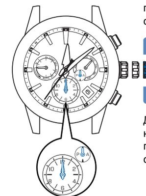
Дополнительный циферблат и индикатор AM/PM движутся вместе.
