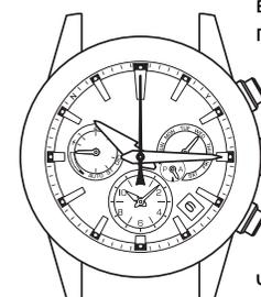
Для движения стрелки без остановки следует быстро крутить головку часов. Перед остановкой хода прокрутите головку еще раз.
