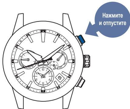
\* При удержании кнопки А в нажатом положении часы переводятся в режим ручной настройки времени.
