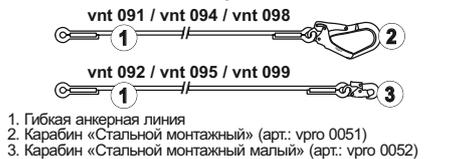
Рис. 2. Необходимое дополнительное оборудование
