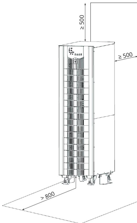
Рис 3-4 Схема размещения ИБП, свободное пространство, мм
