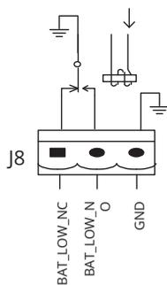
Рис 3-18 Схема интерфейса с «сухими» контактами для предупреждения о низком заряде батарей
