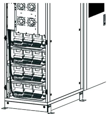
Рис 6-5 Установка защитной панели клеммного терминала подключения батарей
