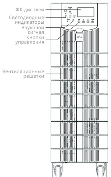
Рис 2-10: Передняя панель ИБП ФОРАЗЗ 10-30кВА
