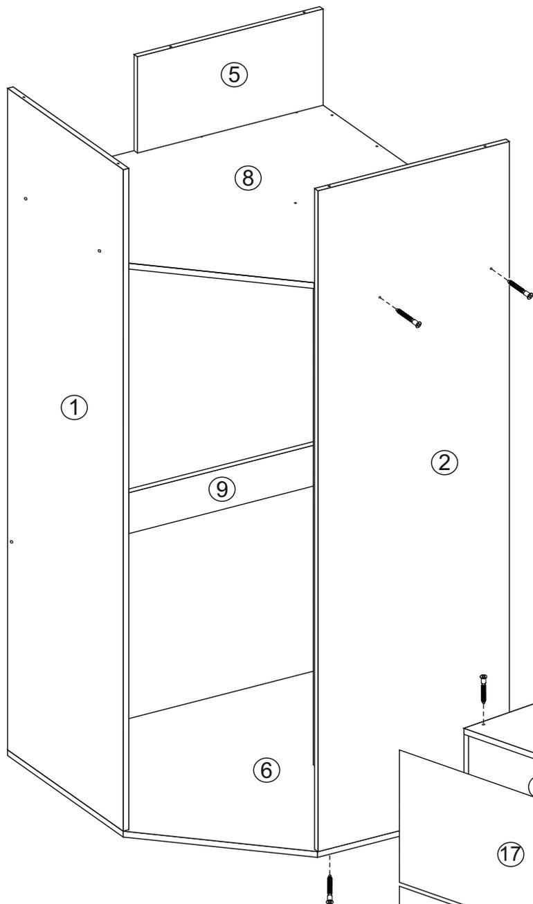
7. Боковину 2 прикрепить к вязке 8 и крышке 6 при помощи еврошурупов 7\*50 мм.
