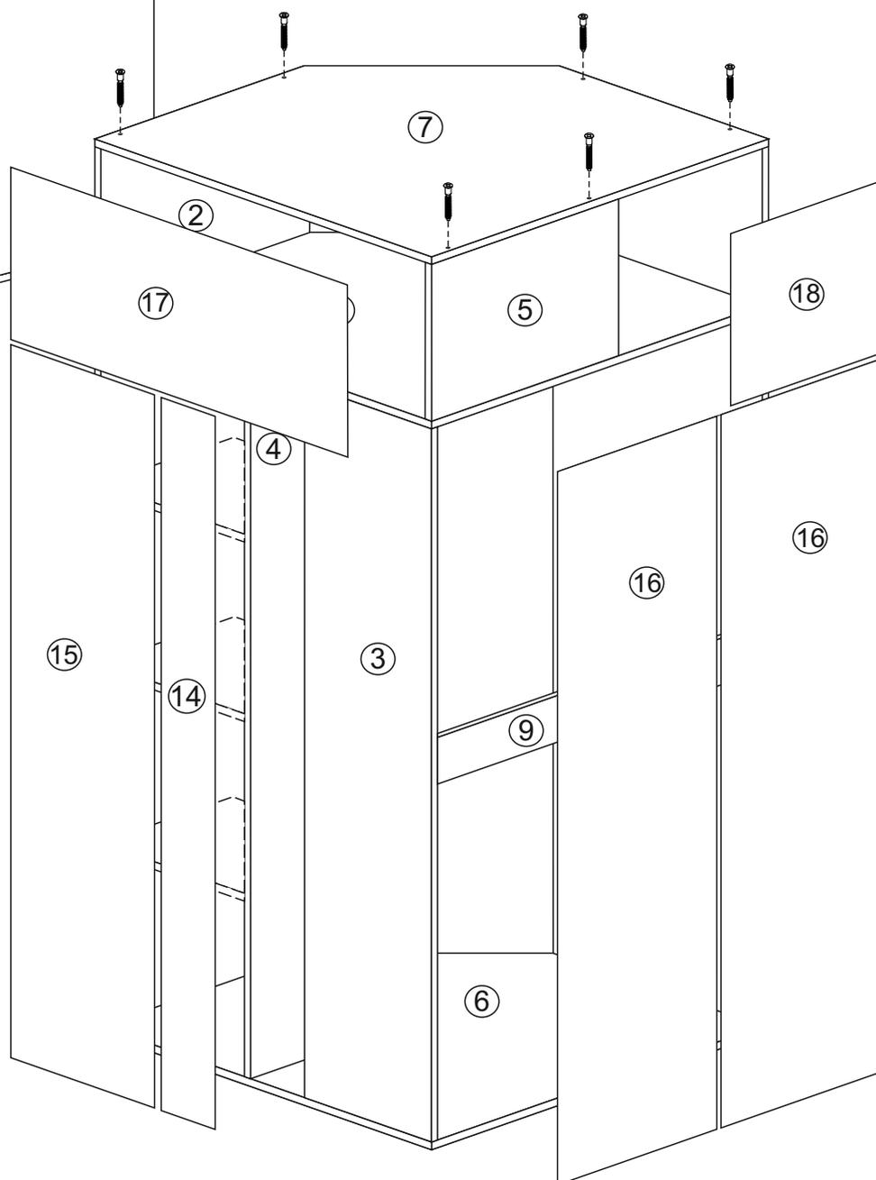
8. Боковину 5 скрепить с вязкой 8, используя еврошурупы 7\*50 мм. Крышку 7 скрепить с боковинами 1, 2 и 3 также еврошурупами 7\*50 мм.
