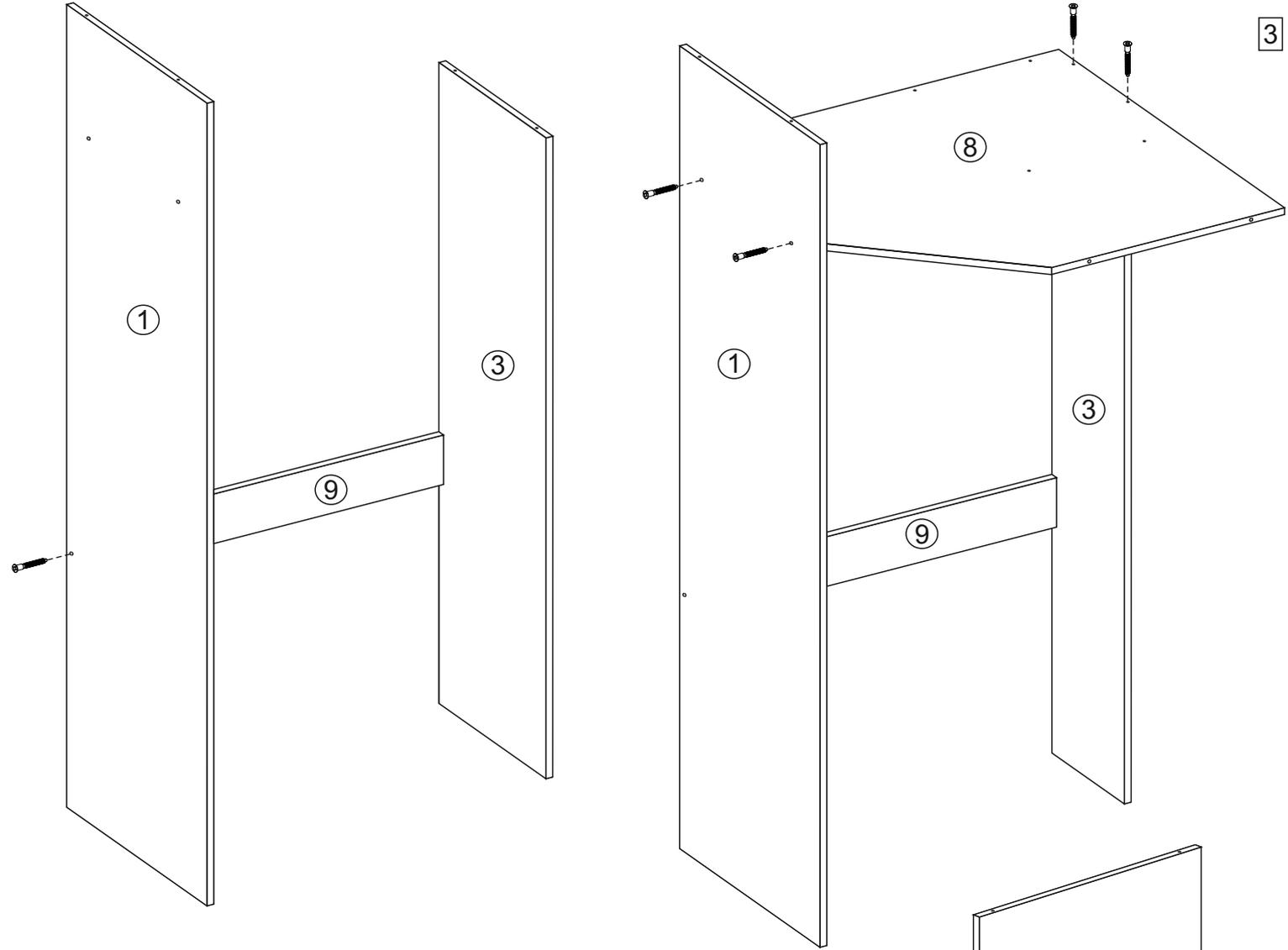
2. Сборку производить горизонтально, тыльной стороной вниз. Предварительно к боковине 1 прикрепить ответные планки угловых петель евровинтами 6,3\*10,5 мм.
