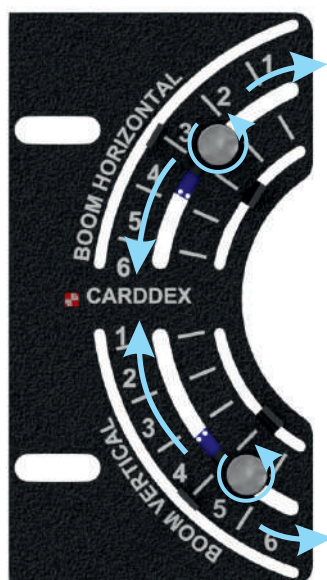
Рисунок 6.5.2 Регулировка положения датчиков
