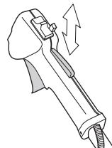
Проверьте, чтобы ручка газа и блокировочный рычаг перемещались свободно и чтобы возвратные пружины работали соответствующим образом.
