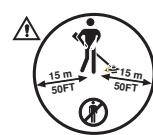
Машины с лезвием для пиления или для травы могут быть подвержены сильной отдаче, когда лезвие соприкасается с неподвижными твердыми предметами. Лезвие в состоянии отрезать руку или ногу. Следите за тем, чтобы на расстоянии 15 метров от машины не находились люди или животные.
