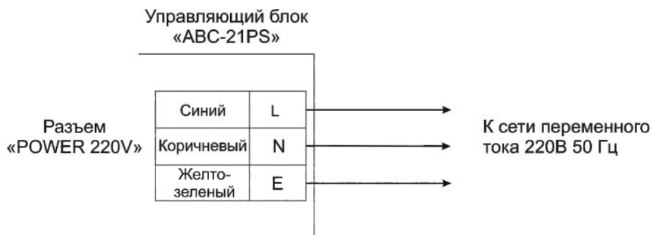
Схема подключения питания к управляющему блоку «ABC-21PS»
