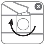
3 Поверните винт в положение «Закрыть».
