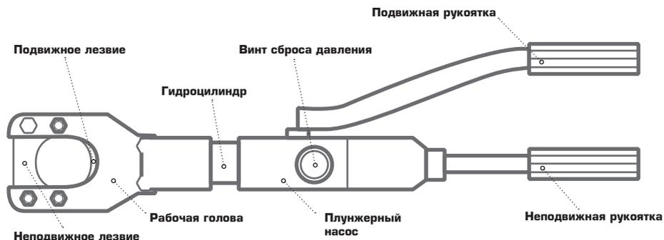
Ножницы гидравлические состоят из гидроцилиндра с режущим узлом, состоящим из подвижного и неподвижного лезвий, корпуса со встроенным двухскоростным насосом плунжерного типа и рукоятки. Нагнетание масла в рабочую полость гидроцилиндра происходит посредством встроенного двухскоростного насоса, приводимого в действие за счет возвратно-поступательных движений подвижной рукоятки. Рабочая жидкость быстро нагнетается, благодаря механизму быстрого хода во
