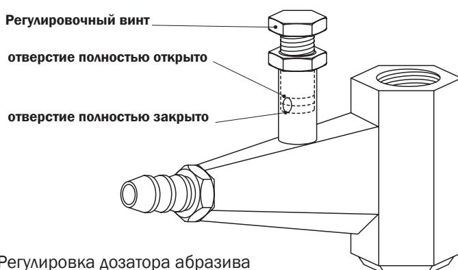
**Рис. 4.3.3.** Регулировка дозатора абразива
