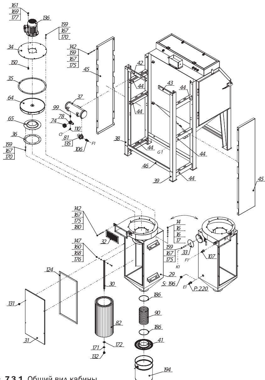
**Рис. 7.3.1.** Общий вид кабины
