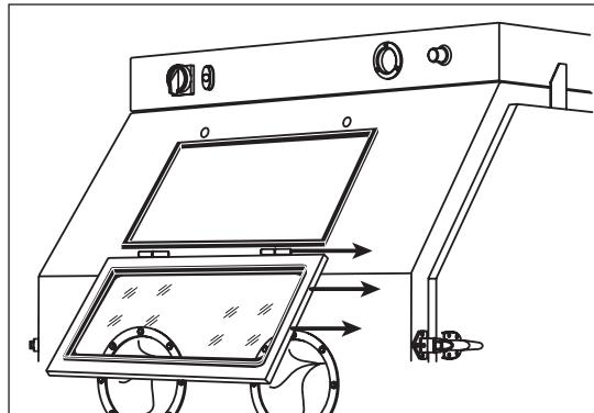
Вставить профиль окна в оконный проем, устанавливая его узкой щелью на металлическую кромку проема. Концы профиля должны соединяться в середине прямой части проема. Профиль необходимо сжать, чтобы его концы оказались плотно соединены.
