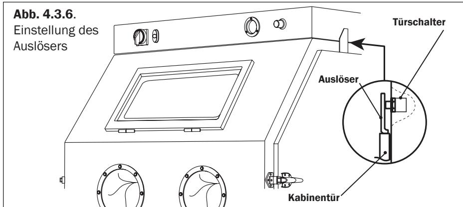
Überprüfen Sie die Funktion sowohl mit offenem als auch mit geschlossenen Türen. Richten Sie die Düse nicht auf die Tür und öffnen Sie die Tür nur soweit, dass der Schalter nicht schließt. Die Türschalter sollten den Strahlvorgang unterbinden, wenn die Türen geöffnet werden und das Strahlen nur bei geschlossenen Türen zulassen.
