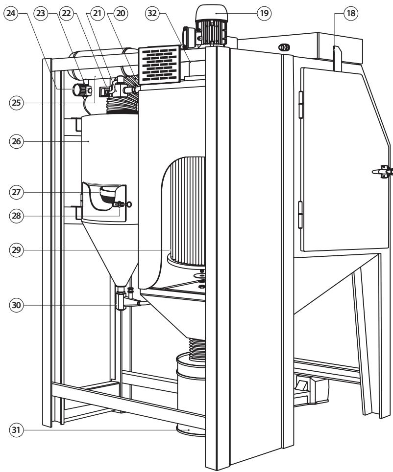
**Abb. 2.0.2.** Übersicht Strahlkabine CAB-110S/135S (Rückansicht)
