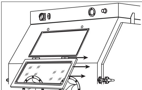
Entfernen Sie das alte Fenster durch Herausziehen des Fensterprofilgummis. Setzen Sie das Fensterprofil in die Fensteröffnung ein, indem Sie den engen Schlitz über die Metallkante der Öffnung stülpen.
