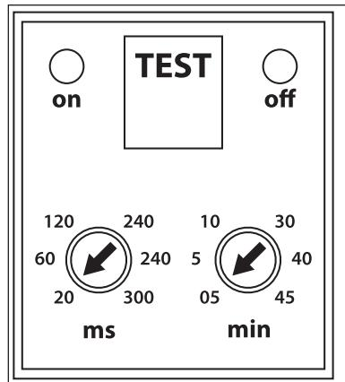
**Abb. 4.3.8.** Einstellung der Impulsdauer und der Impulsintervall
