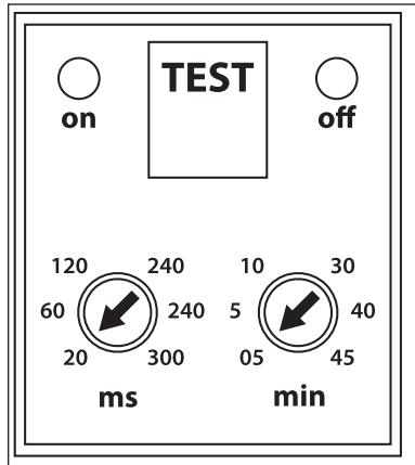
**Рис. 4.3.8.** Регулировка длительности импульса и цикличность на таймере
