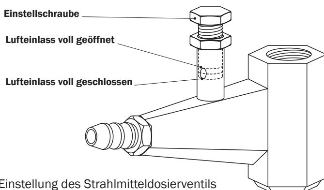
**Abb. 4.3.3.** Einstellung des Strahlmitteldosierventils
