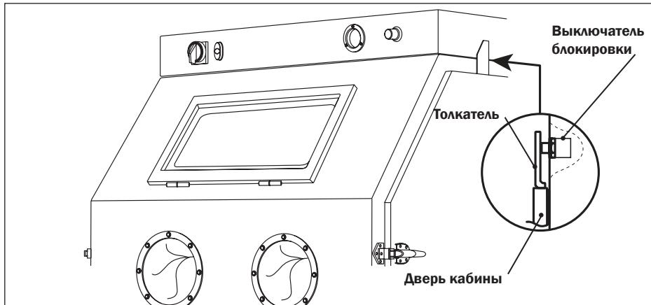
**Рис. 4.3.6. Регулировка толкателя**
