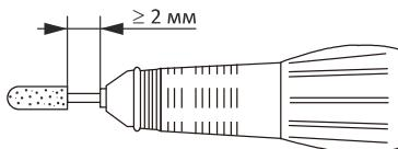
Смену насадки следует производить только при выключенном микромотре. В противном случае аппарат может выйти из строя.
