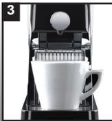
Закройте переднюю крышку, разместив большую чашку кофе под дозатором (E) и нажмите на кнопку КОФЕ, для наполнения стакана.
