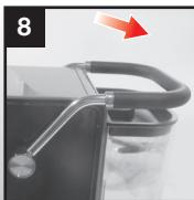
Cerrar el contenedor de cápsulas (H) empujando la palanca (I) hasta que alcance la posición horizontal.
