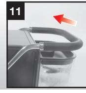
La capsula viene espulsa automaticamente aprendo la sede inserimento capsule (H) tirando la leva (I) fino al raggiungimento della posizione verticale. Le capsule cadono nel cesto capsule usate (C).
