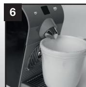
Colocar un contenedor bajo la boquilla de salida del café (E).
