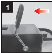
Ouvrir le logement d'insertion des capsules (H) en tirant sur le levier (I) pour le placer en position verticale.
