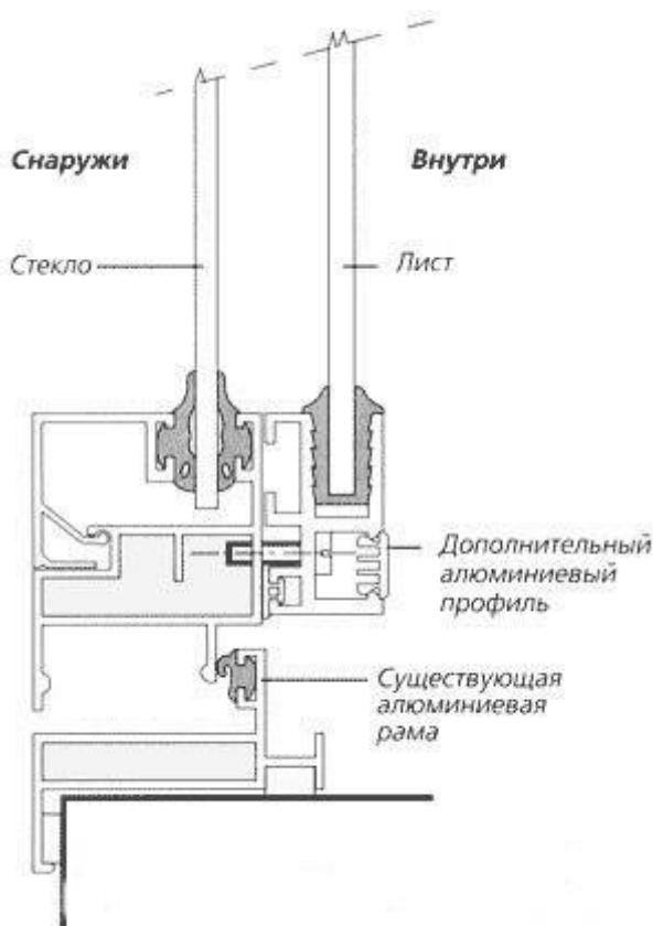
**Рис. 9. Внутреннее дополнительное остекление.**
