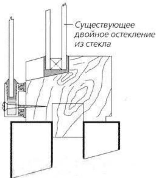
**Рис. 10. Внешнее дополнительное остекление.**
