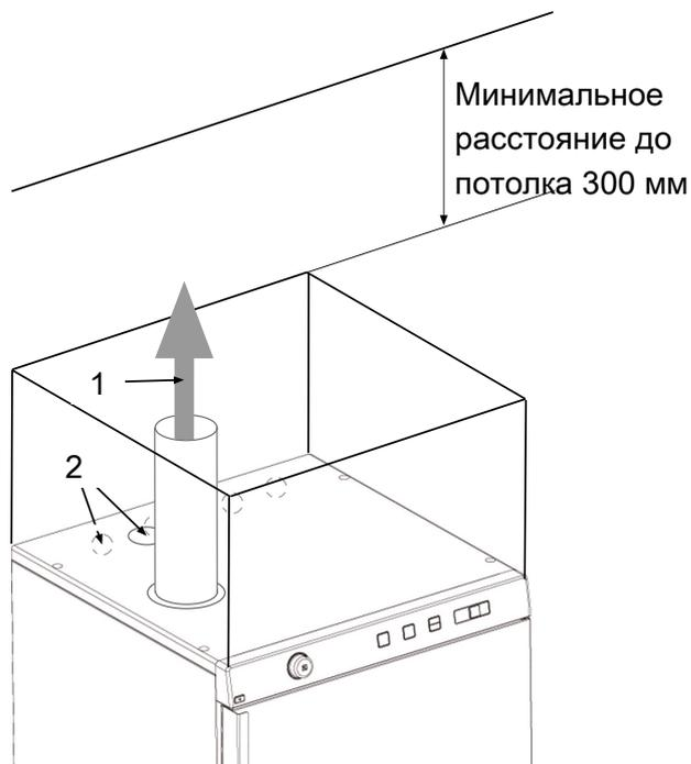
Отработанный воздух отводится в помещение, в котором установлен сушильный шкаф. Сушильный шкаф внутри встроенного шкафа.
