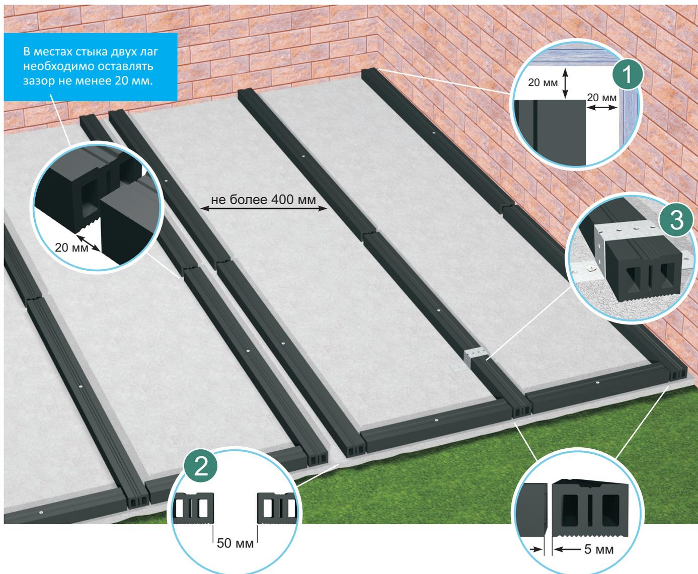
Лага является опорным, а не несущим элементом. Поэтому, лага должна лежать всей нижней поверхностью на основании (бетонная стяжка, тротуарная плитка и т. д.)
