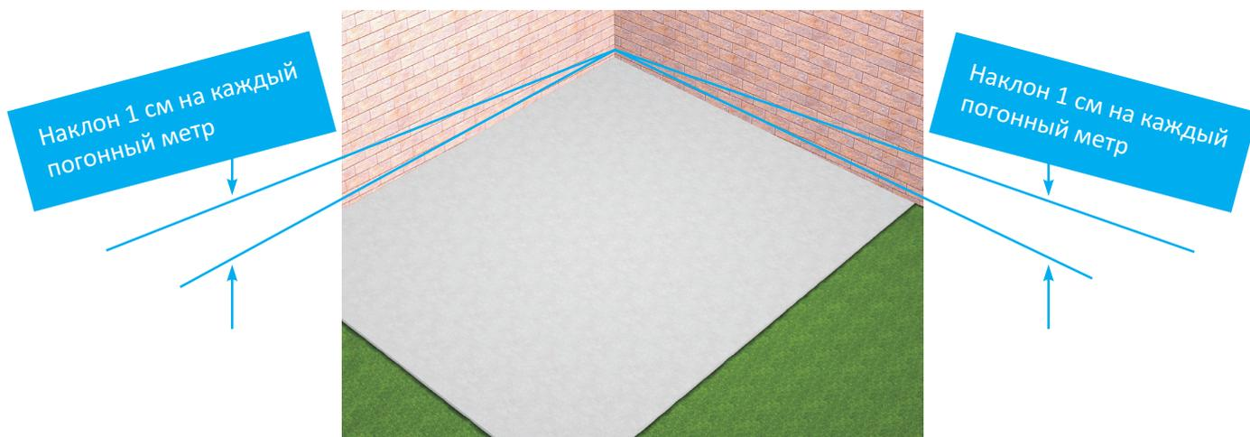
Для отвода дождевой и талой воды в случае бетонной стяжки рекомендуется делать уклоны от статических сооружений или дренаж во всех других случаях. Наклон 1 см на каждый погонный метр.
