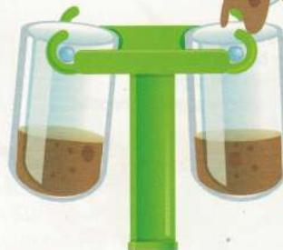
Осторожно насыпьте влажную грязь в пробирки на центрифуге примерно до 1 полной ложке. Убедитесь, что уровни равны. Готовы вращать? Покрутите рукоятку в течение 60-90 секунд! Теперь проверьте смесь: отделилась ли вода от грязи? Осела ли грязь на дне? Осторожно слейте воду из пробирок и изучите этот осадок!
