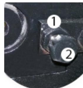
б) Для кабеля/провода диаметром 28-45 мм: если кабели/провода не были разделены должным образом (разрезы слишком мелкие или слишком глубокие) отрегулируйте устройство с помощью регулятора (1) на рисунке ниже:
