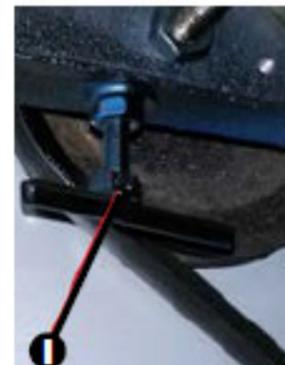
Эти регуляторы находятся под нижним валом, над двигателем. Затягивание приведёт к увеличению зазора между нижним и верхним валами (к более мелкому прорезанию), откручивание приведёт к уменьшению зазора между нижним и верхним валами (к более глубокому прорезанию).
