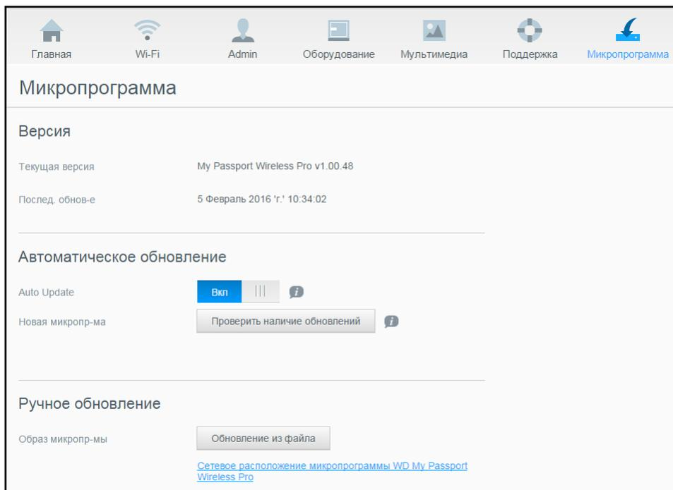
2. В области «Версия» в поле «Текущая версия» отображается версия встроенной программы, установленной на накопитель. В поле «Послед. обнов-е» отображается дата последнего обновления встроенной программы.
