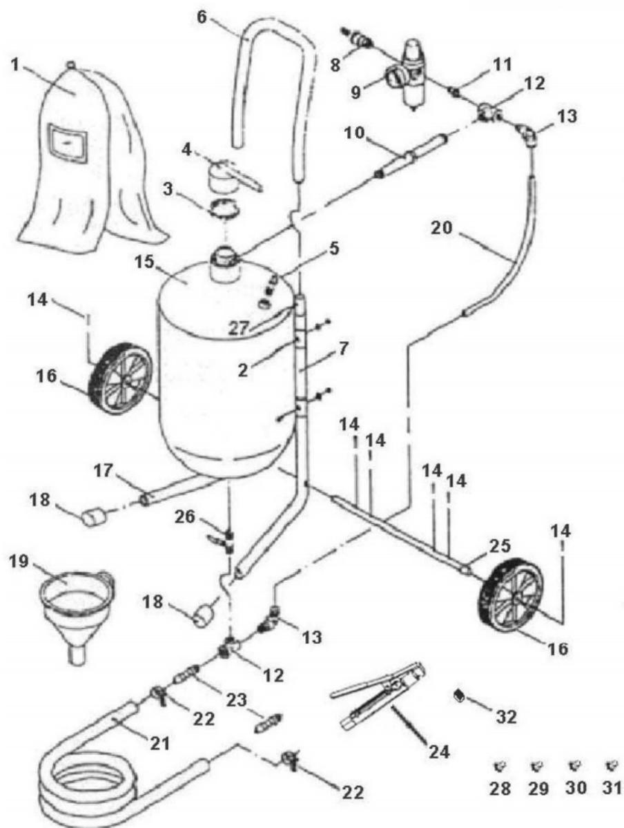
Рис. 1. Устройство аппарата.
