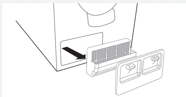
5. Выньте из корпуса А губчатый фильтр В и пропылесосьте фильтр или промойте его проточной водой.
