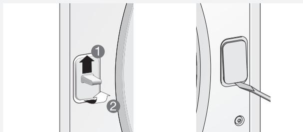
7. Установите дверцу, слегка ослабив винты петель, приставив дверцу и закрыв ее. Затяните петли. Установите панель.
