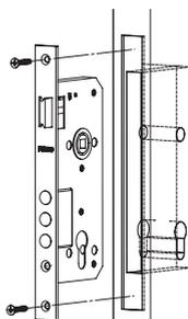
3. Установите цилиндр (А) и зафиксируйте его винтом (В).
