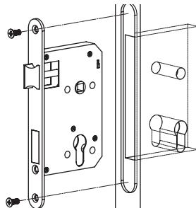
3. Установите цилиндр (A) (не входит в комплект). Зафиксируйте его винтом (B).
