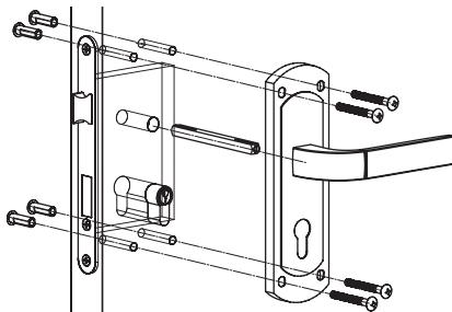
5. По установленному замку отметьте место установки ответной планки на дверной коробке. Сделайте пазы под защелку и ригели. Закрепите ответную планку при помощи саморезов.
