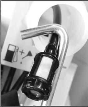
Рис.10 Извлечение топливного фильтра
