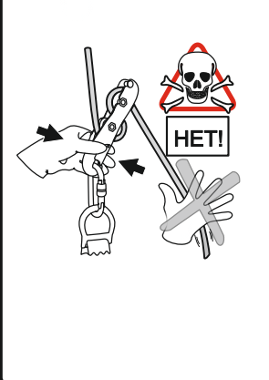
Рис. 13. Подъем с использованием зажима со стремнем
