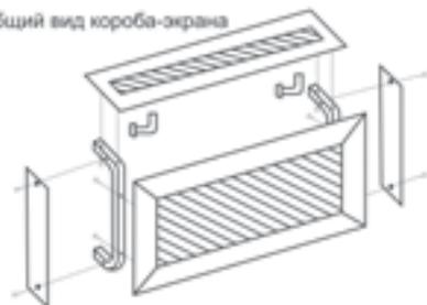
**2** Закрепить верхний экран на кронштейнах, через отверстия А саморезами №8. Соединить верхний и фасадный экраны уголком №11.
