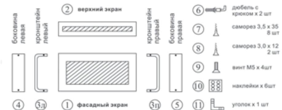
**1** Закрепить кронштейны №3 на фасадном экране, с отступом 8 мм от края экрана. В отверстия А вкрутить саморезы №7.
