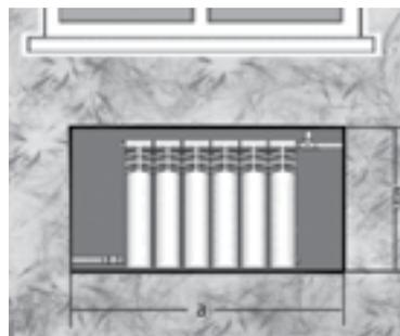
1. Снимаем мерки для экрана с шириной профиля 70 мм:
