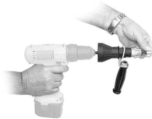
4. Установите заклепку в отверстие. Нажмите кнопку пуск (правое вращение). Вращение установочного винта за 2-3 секунды с характерным треском зафиксирует заклепку в отверстии. Заклепка установлена.
