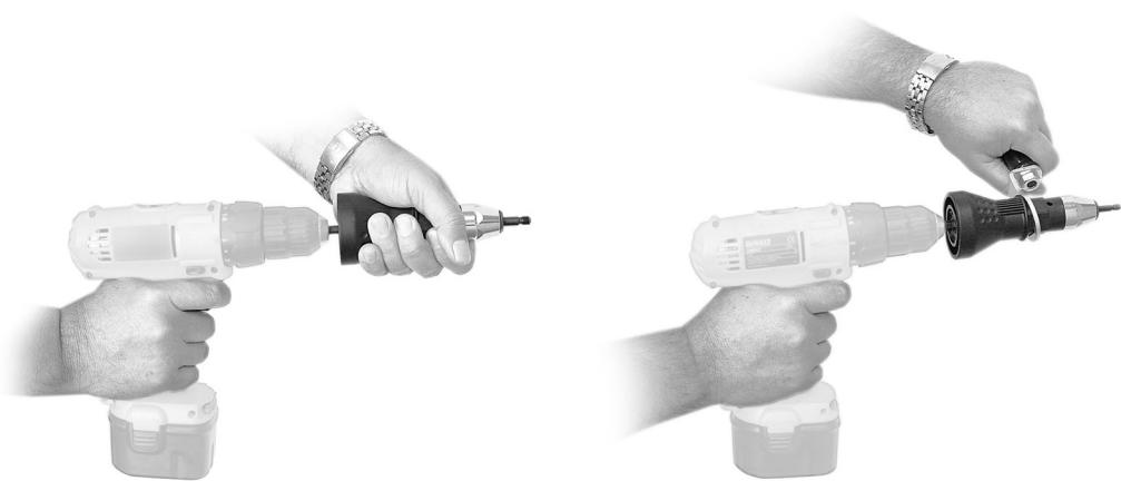
3. Диаметр заклепки должен соответствовать диаметру установочного отверстия. Установите заклепку на установочный винт. Слегка придерживая заклепку, включите инструмент (правое вращение), чтобы заклепка прижалась бортиком к фиксирующей гайке. (Допускается накручивание заклепки на установочный винт «вручную»)
