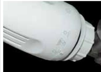
В положении ☼ → режим настройки ограничен диапазоном от 0 до требуемого значения параметра настройки. Например: зафиксируйте ручку регулятора термостатической головки в положении «3», а ограничительное кольцо - в положении ☼ →. Таким образом, вы сможете полностью открыть термостатическую головку, или полностью закрыть ее в положении максимального закрытия «3».
