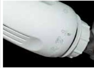
В положении 0 → режим настройки ограничен диапазоном от 0 до требуемого значения параметра настройки. Например: зафиксируйте ручку регулятора термостатической головки в положении «3», а ограничительное кольцо - в положении 0 →. Таким образом, вы сможете полностью закрыть термостатическую головку, или полностью открыть ее в положении максимального открытия «3».
