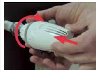
Установите термостатическую головку в положение максимального открытия.
