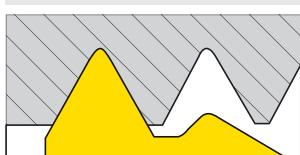
При нарезании резьбы неполным профилем СМП не производится обработка наружного диаметра, однако СМП может быть использована для широкого диапазона шагов резьб.
