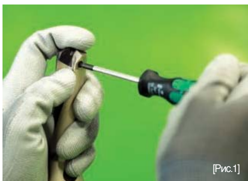
Закрепление пластины в корпусе
