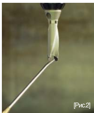
Замена пластины в корпусе сверла установленного на станке
