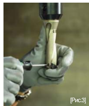
Замена пластины в корпусе сверла установленного на станке
