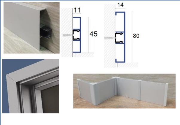
Двухсекционный плнтус состоит из базы, выполненной из алюминия и декоративной верхней части из анодированного алюминия. База крепится прямо на стену с помощью саморезов и позволяет укрыть низковольтные кабели, кроме того, она повышает долговечность и противостоит сырости. Крепёж фиксируется по всей длине плнтуса. Зазор от стены составляет 14 мм.
