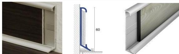
Плинтус предназначен специально для использования с ковровином или линолеумом. По конструкции похож на плинтус с кабель-каналом, однако не имеет вкладки, вместо кабеля в него вставляются полосы ковровина толщиной от 5 до 8 мм.
