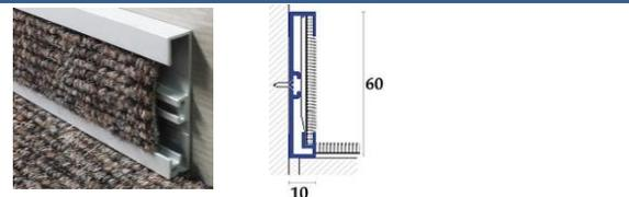
Прямоугольный плинтус предназначен специально для использования с ковровином или линолеумом. По конструкции похож на плинтус с кабель-каналом, однако не имеет вкладки, вместо кабеля в него вставляются полосы ковровина толщиной от 2 до 6 мм.
