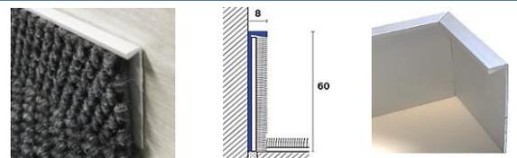
Специально разработанный вид плинтуса, который предназначен для монтажа в помещениях с ковровым напольным покрытием. Изделие представляет собой планку из анод.алюминия. В профиль плинтуса вставляется лента ковровина высотой 60 мм. Ковролин крепится к плинтусу при помощи клеевой ленты, нанесенной на лицевую часть планки. Таким образом удается достичь фактурного и цветового единства в отделке пола.
