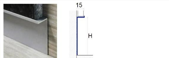
Плинтус, изготовленный из анодированного алюминия и имеющий две высоты (40 и 70 мм), он рекомендован для монтажа панелей из гипсокартона непосредственно на стену. Плинтус легко устанавливается на специальный клей.
