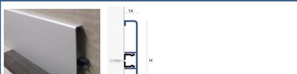
Двухсекционный плнтус состоит из базы, выполненной из алюминия и декоративной верхней части из анодированного алюминия. База крепится прямо на стену с помощью саморезов и позволяет укрыть кабели, кроме того, она повышает долговечность и противостоит сырости. Крепёж фиксируется по всей длине плнтуса. Зазор от стены составляет 14 мм.
