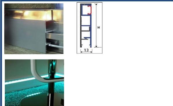
Плинтус, из анодированного алюминия с системой светодиодного освещения, состоящий из двух частей и имеющий кабель канал для проводов. В комплект входят – опора, которая закрепляется к стене с помощью винтового соединения, и верхнего съемного профиля. Данный плинтус подходит со встроенной системой для стен из гипсокартона. Плинтус можно перевернуть, где именно Вы хотите увидеть фронтальную подсветку внизу или верху плинтуса. **Красим по каталогу RAL.**
