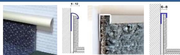
Завершающий профиль для напольных покрытий является гармоничным завершением коврового покрытия, также обеспечивает хорошую защиту краев, препятствует их деформации и разрушению.
