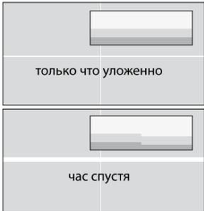
9. Выровнять поверхности, делая допуск на возможную осадку уложенного материала, таким образом можно избежать небольшую разницу уровней в будущем.
