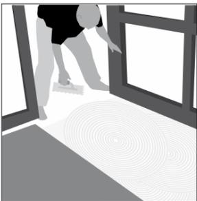
6. Рекомендуется система облицовки, при которой наносится тонкий слой эластичной клеящей мастики. Такой тип клеевого состава довольно долго сохраняет эластичность. Для плитки 3+ армированной стекловолокном рекомендуется техника нанесения двойного слоя клеевого состава: один слой наносится на облицовочную поверхность, а другой на обратную сторону плитки. Особое внимание обращают на то, чтобы полностью покрыть клеем уголки плитки
