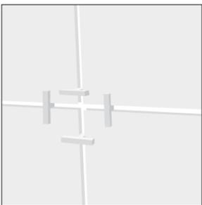
8. Согласно «Справочнику по плитам из керамогранита», ширина шва между двумя плитками должна превышать 1,5 мм. Используемые для этого клинья-крестики должны быть по меньшей мере 1 мм толщиной.
