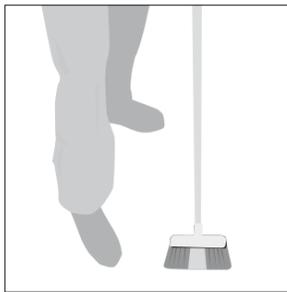
3. Для лучшего «схватывания» клеящего раствора, облицовочную поверхность следует предварительно очистить.
