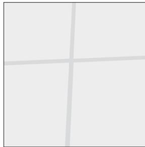
12. Затирку швов производят после того, как плитка приклеится к облицовочной поверхности (см. Рекомендации производителей клеевого состава)
