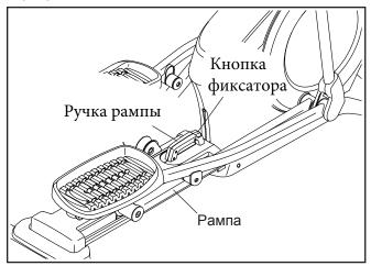
Чтобы опустить рампу, нажмите кнопку иксатора, потяните а ручку и опустите рампу, установив нужный наклон. атем опустите кнопку и вставьте фиксирующий стержень в одной из регулировочных отверстий на раме. Убедитесь, что стержень надежно вставлен в отверстие.
