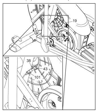
Затем ослабьте указанный винт М4 х 16 мм (101). Немного переместите геркон (38) от или к магниту (43), а затем затяните винт. Затем, подключите адаптер, и качните шкив (19) вперед и назад так, чтобы магнит (43) проходил геркон (38) неоднократно. Повторяйте эти действия до тех пор, пока консоль не начнет показывать корректные данные.
