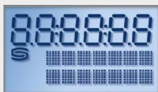
С помощью интерфейса EtherCAT можно запрограммировать индикацию на ЖК-дисплее. Если выбрана одна выходная величина, она отображается постоянно, при выборе нескольких величин они показываются поочередно.
