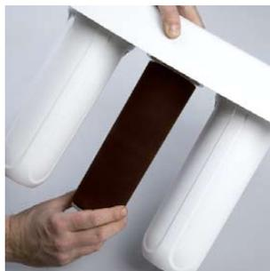
Очистить внешнюю поверхность картриджа мягкой щеткой (например, платяной) под струей воды.
