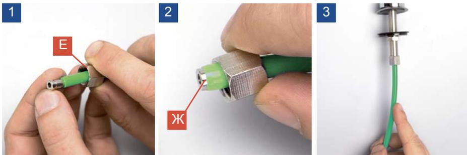
В гайку (Е) проденьте пластиковую трубку (рис. 1). Пистон (Ж) вставьте внутрь трубки до упора (рис. 2). Закрутите на резьбовой шток крана гайку (рис. 3).
