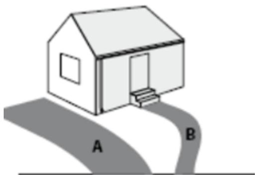
Когда с помощью DEVIreg™ 850 IV управляют более чем одной зоной, имеется возможность установить приоритет включения зон. Установка приоритета делает возможной работу двух зон даже в том случае, когда выделенная электрическая мощность недостаточна для их одновременного включения.
