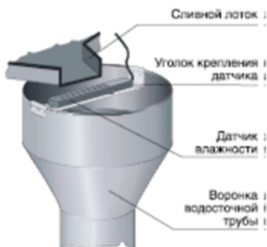
Датчик для Кровли состоит из двух частей – собственно сам датчик влажности и температуры и кабель длиной 15 м для подключения регулятора Devireg 850.
