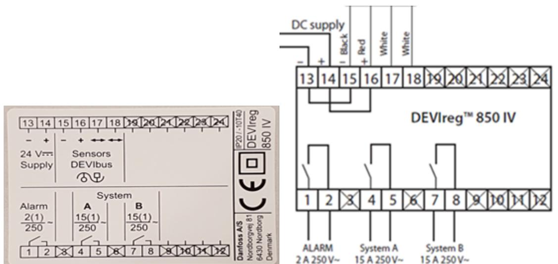
На передней панели имеются 3 кнопки управления и двухстрочный дисплей. Источником питания терморегулятора DEVIreg™ 850 IV и цифровых датчиков является блок питания ABB CP-D 24/2,5, выполненный в виде отдельного аппарата, устанавливаемого на DIN-рейке. Выходная нагрузка блока питания: 2,5 А при напряжении 24 В.
